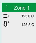
Die Zone befindet sich im Regel-Modus, der Temperatur-Istwert befindet sich im vorgegebenen Toleranzband, es liegt kein Fehler vor.
