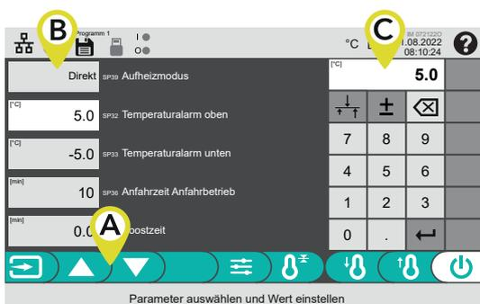
**A** Die Anzeigeseite mit dem zu ändernden Systemparameter über die Pfeiltasten auswählen. Parameter, die nur nach dem [Login](#) geändert werden können, sind mit einem Schlüsselsymbol in der linken unteren Ecke gekennzeichnet.
