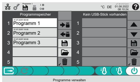
Im Programmspeicher des Geräts können fünf Werkzeugeinstellungen (Werkzeugprogramme) gespeichert werden. Ein Werkzeugprogramm umfasst alle Zonen- und Systemparameter.
