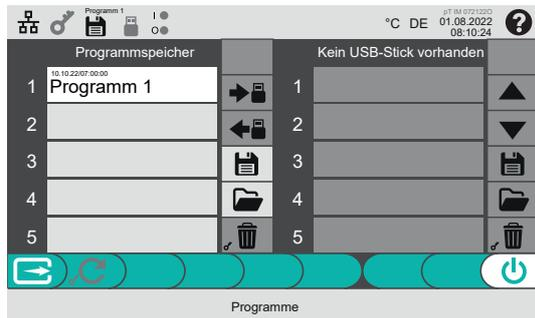
Der Programmname in der Kopfzeile kennzeichnet das gerade geladene Werkzeugprogramm. Bei der nächsten Änderung eines Einstellwerts wird der Programmname in der Kopfzeile wieder ausgeblendet. Denn dann stimmen die Einstellwerte im Gerät mit den Einstellungen im Werkzeugprogramm nicht mehr überein.
